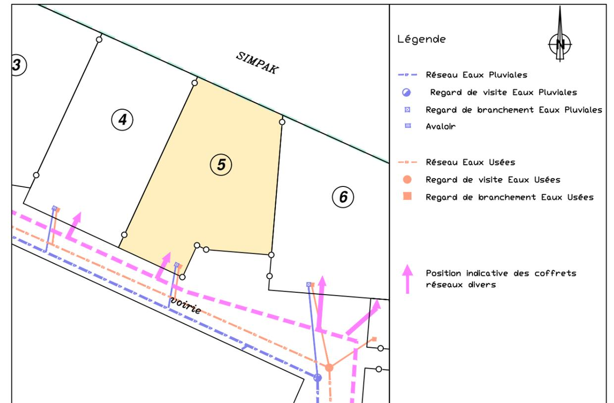
Nota : Les éléments techniques figurés sur l'extrait de plan VRD sont positionnés à titre indicatif, et peuvent être déplacés ou adaptés lors de la phase de chantier. Leur implantation ne sera définitive qu'après la réalisation des travaux du constructeur.
